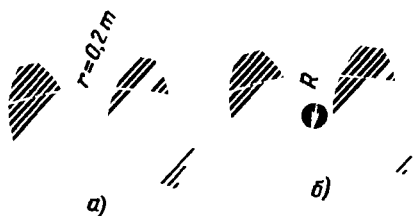
Рис. 594. Эвольвентные шлицы с впадиной: а — стандартного профиля; б — закругленной
